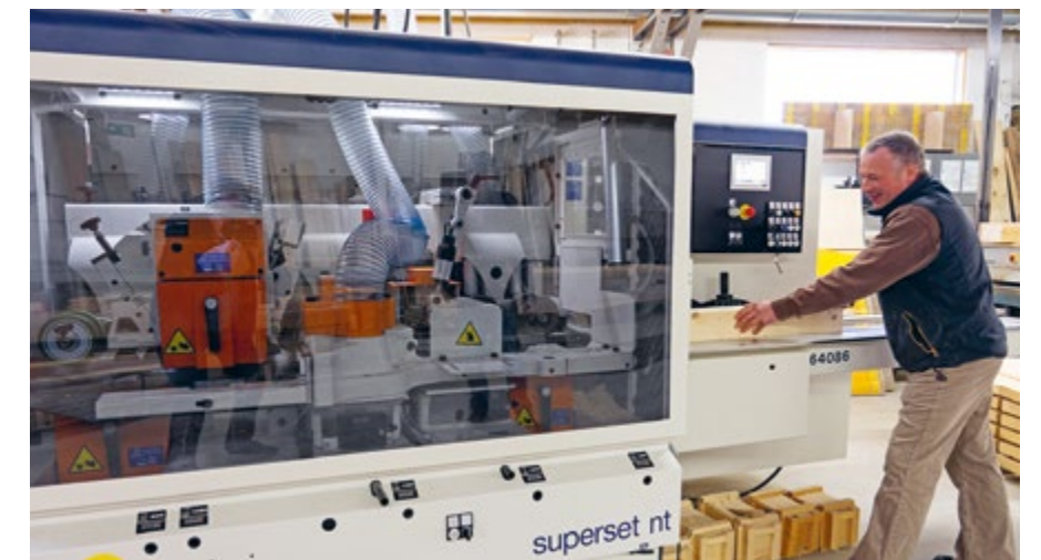
Schreiner Thomas Thiel „füttert“ das neue Holzbearbeitungszentrum mit einem Vierkantholz.
