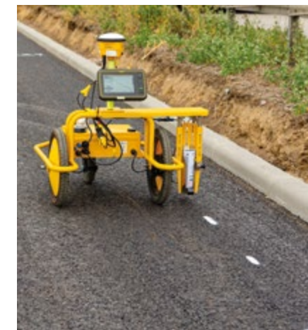
Hinterließ Spuren: Der Absteckroboter sprühte im Meterabstand einen weißen Markierungsstrich auf.
